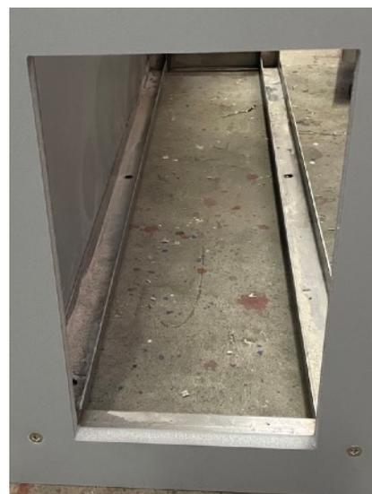
6 points d'encrage au sol et 2 points d'encrage mur.
